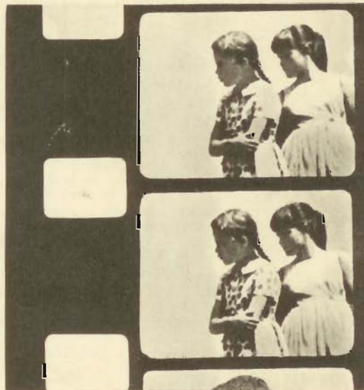
Рис. 2. Формат кадра и расположение перфораций на пленке «Супер-8»
